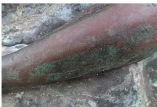
Essais de nettoyage et de traitement de quelques surfaces des reliefs en bronze.
