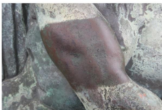
Essais de nettoyage et de traitement de quelques surfaces des reliefs en bronze.
